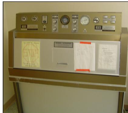
Fig. 6. Weatherometer
